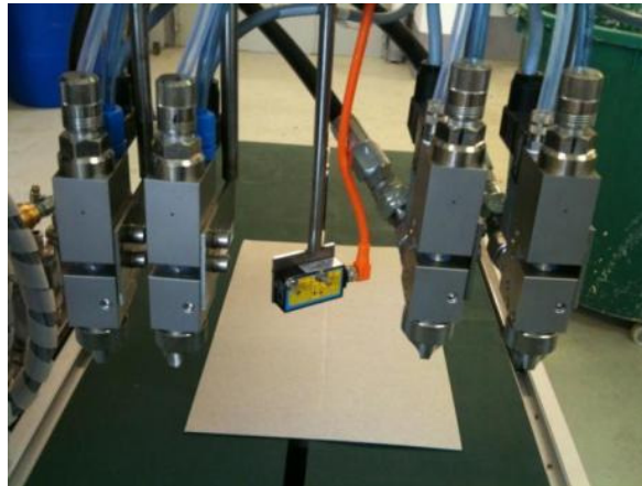
Abbildung 33: Düsen und Initiator der Kallleimsprühanlage
