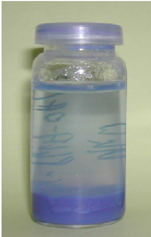
Abbildung 19. Farbstoffgefüllte Mikrokapseln, die durch Grenzflächenpolykondensation eines Polylactid-Makromonomeren hergestellt wurden.
